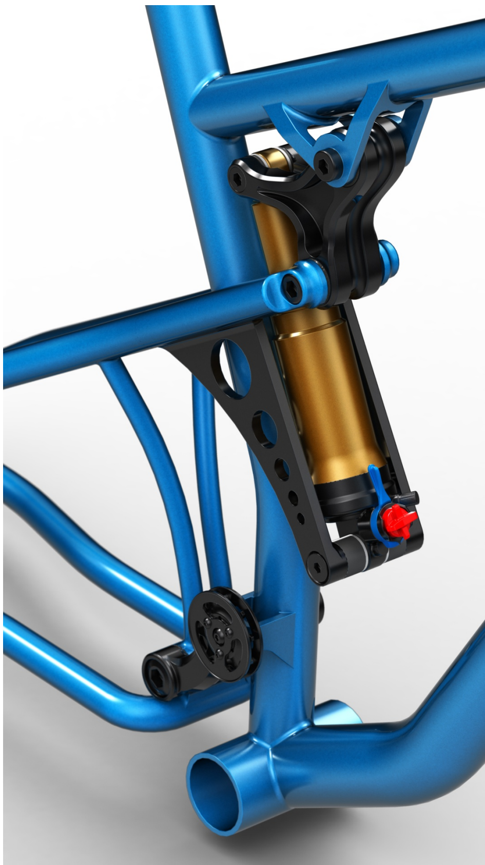
Obr. F.4 – Detail vahadla a uchytenia tlmiča
