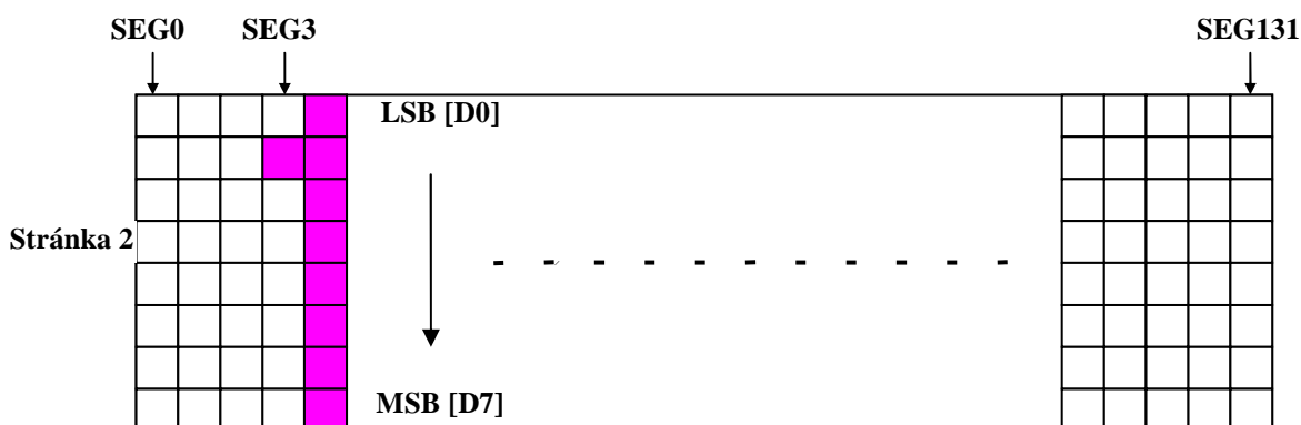
Obr. 5.13: Příklad nastavení konkrétních bitů v GDDRAM.
