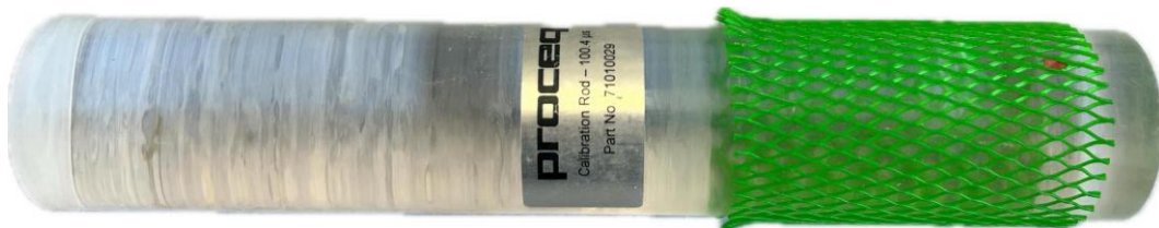
Obr. 5: Etalónový valec určený na kalibráciu.
