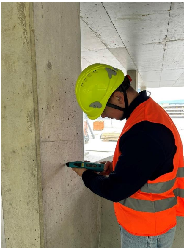
Obr. 42: Terén - stĺp 1 meranie pomocou Schmidtovho tvrdomeru.
