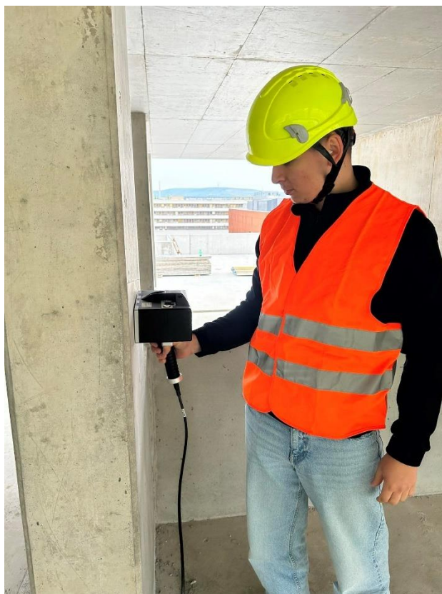
Obr. 41: Terén - stĺp 1 meranie pomocou ultrazvuku.
