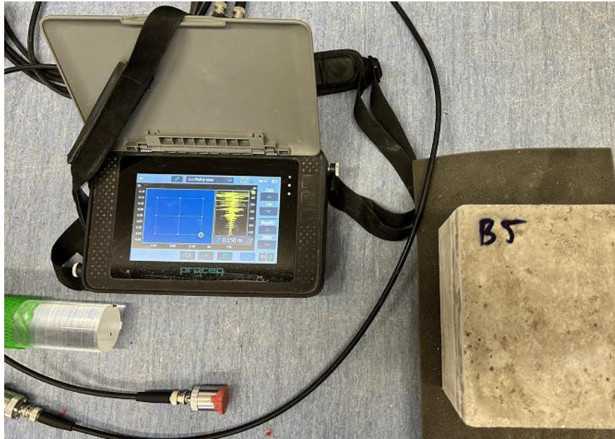
Obr. 19: Meranie UZ prístrojom Pundit-PL 200.
