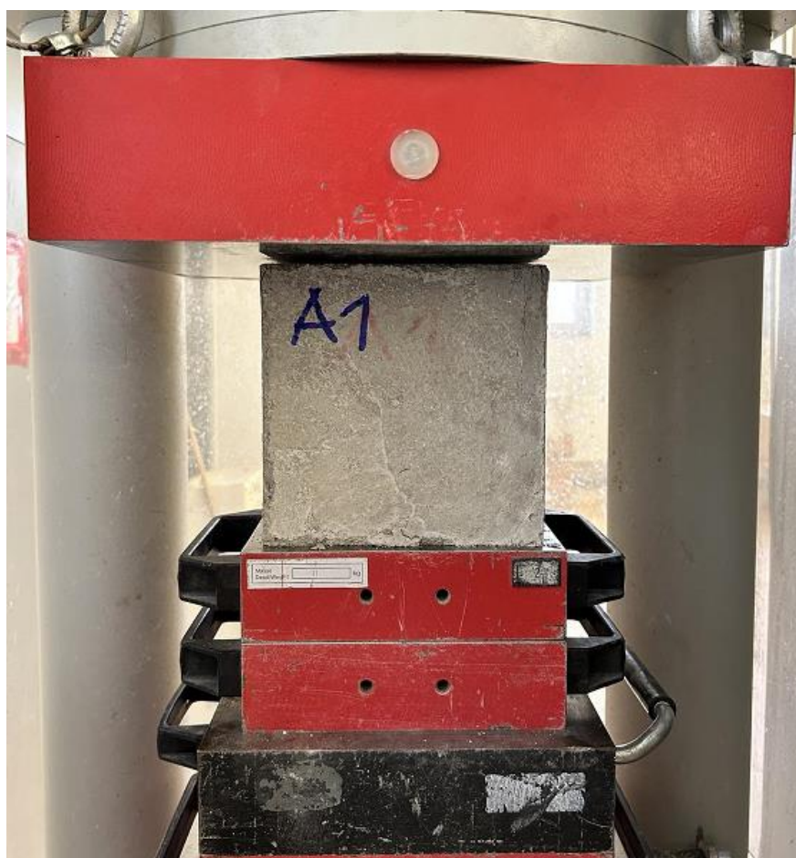
Obr. 21: Meranie maximálneho porušenia lisom.
