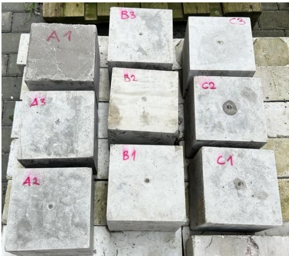
Obr. 17: Telesá uložené vo vonkajších podmienkach.
