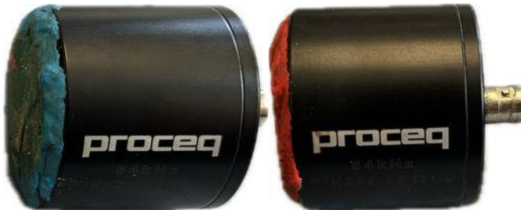
Obr. 4: Sondy so spojovacím materiálom (plastelína).
