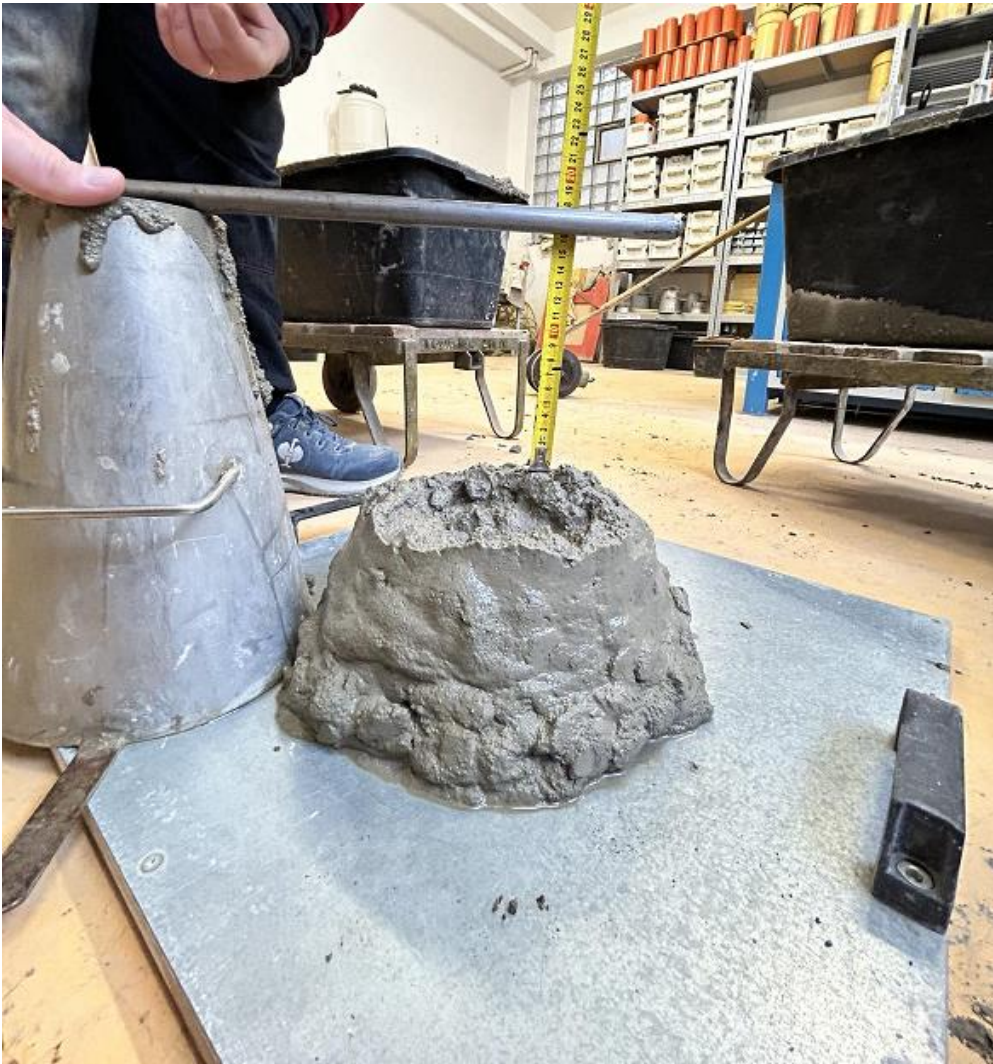
Obr. 15: Skúška sadania kužela (165 mm).
