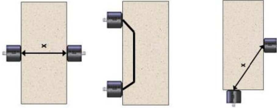
Obr. 3: Postavenie sond a šírenie ultrazvuku [17].
