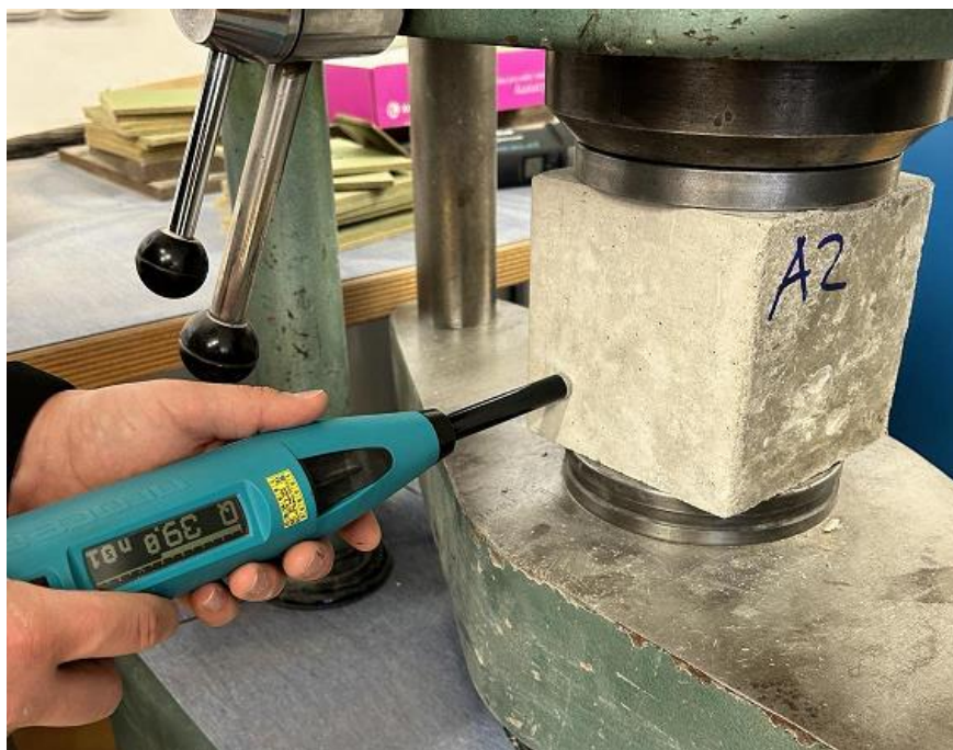
Obr. 20: Skúšobné teleso upnuté lisom, Silver Schmidt typu N.
