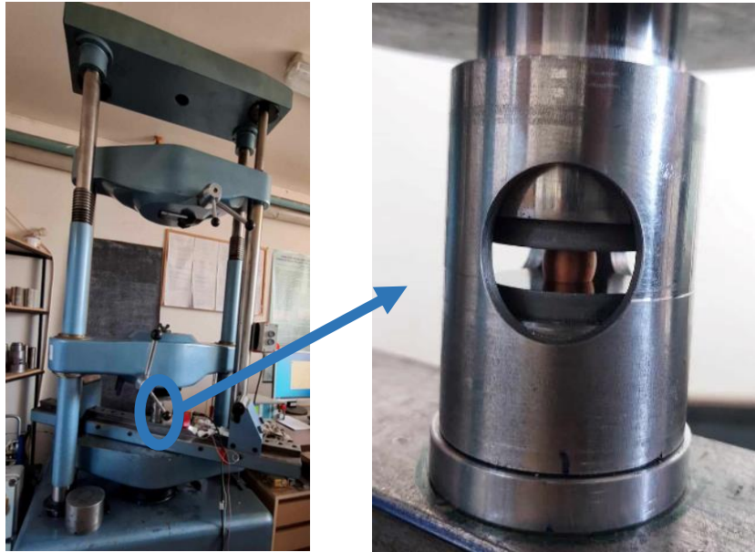
Obr. 51 Pýchování vzorku na zařízení ZD 40.
