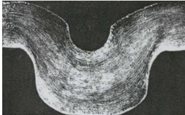
Obr. 24 Deformovaná struktura kovu – vlákna [66].
