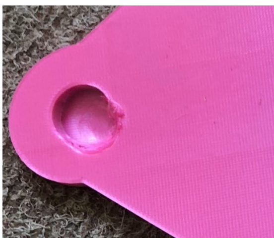
Obr. 6.12: Deformácia aktívneho ramena na dolnej časti rotora pohľad a) zhora, b) zo spodku
