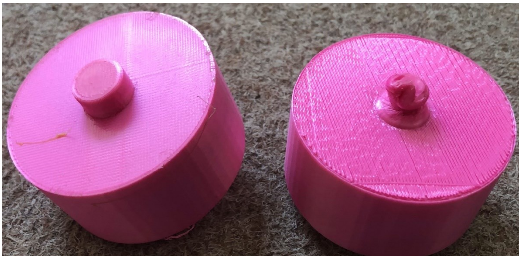
Obr. 6.11: Porovnanie nedeformovaného a deformovaného valčeka rotora
