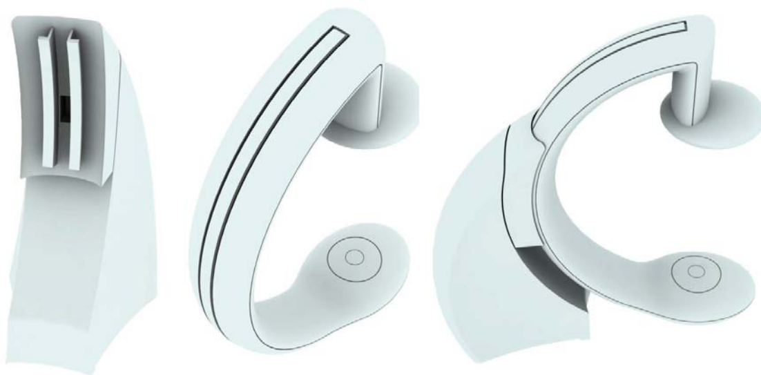
Obr. 2.12 Podstava s vedením, C-rameno a komplet
