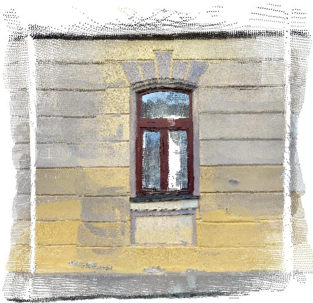
Obr. 18 Mračno bodů pořízené metodou laserového skenování | obrázek autor
