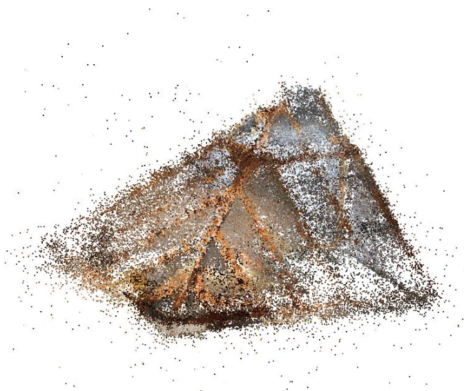
Obr. 13 Mračno bodů (krovová výseč) pořízené fotogrammetrickou metodou | obrázek autor
