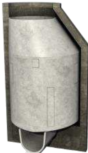
Obr. 6.3. Schéma vyložení šachty segmenty DURAPORT [43]
