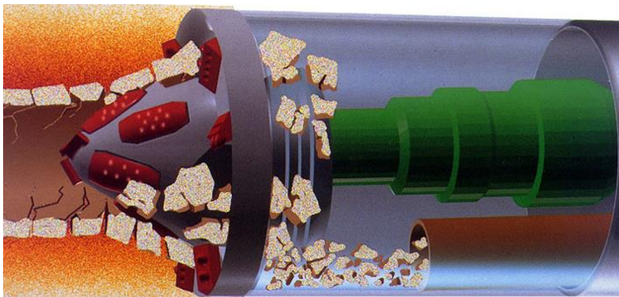
Obr. 4.13. Ukázka práce plnoprofilové frézy [5]
