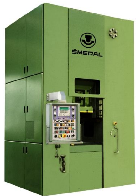
Obr. 16 Kolenový lis řady LLR [23]
