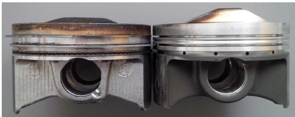
Obr. 27 Srovnání sériového pístu Honda (vlevo) se závodním pístem TODA (vpravo)
