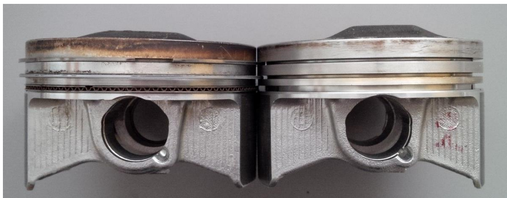
Obr. 22 Srovnání sériového pístu Honda pro evropský trh (vlevo) a sériového pístu Honda pro japonský trh (vpravo)
