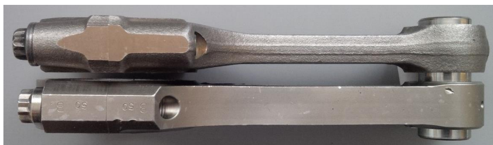
Obr. 23 Srovnání sériové ojnice Honda (nahore) a závodní ojnice TODA (dole)
