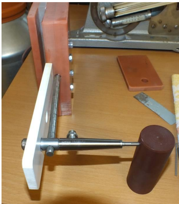
Obr. 5.2: Nové tělo při ustavování do správné pozice pomocí speciálního přípravku [foto: M. JURČOVÁ]
