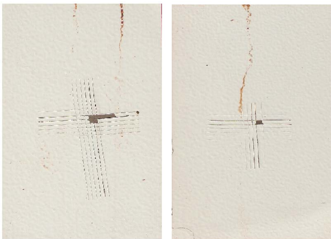
Obr. 10 Fosfát 1 – PNH 1 po 480 hod expozice (vlevo – vzorek č. 12 ) a po 750 hod (vpravo – vzorek č. 16)
