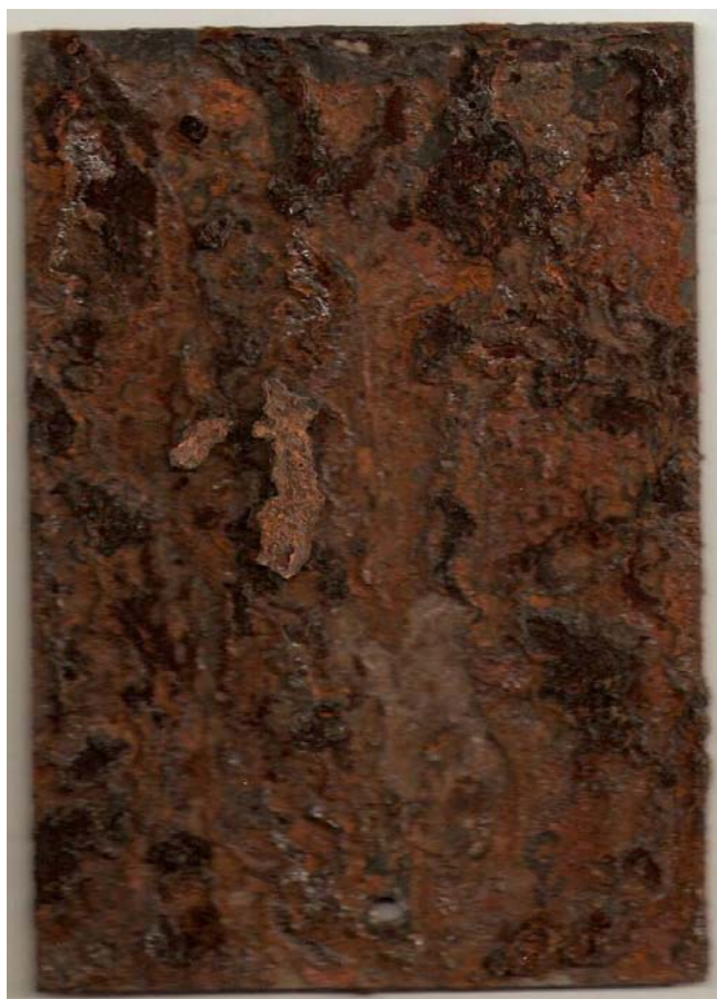
Obr. 14 Vzorek č. 3 po 480 hod expozice
