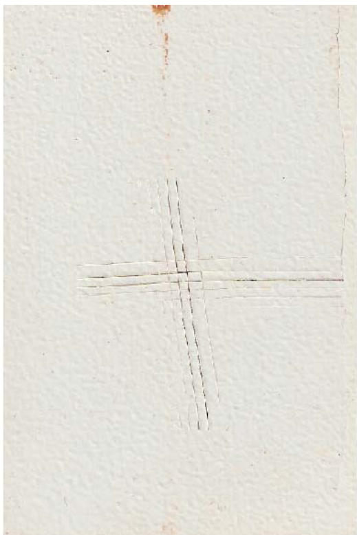
Obr. 11 Fosfát 1 – PNH 2 po 480 hod expozice (vlevo – vzorek č.19) a po 750 hod (vpravo – vzorek č. 24 )
