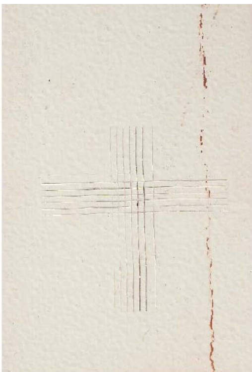
Obr. 12 Fosfát 2 – PNH 1 po 480 hod expozice (vlevo – vzorek č. 26) a po 750 hod (vpravo – vzorek č. 30)
