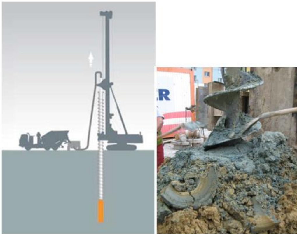
Obr. 6 Schéma postupu vrtu piloty, čerpání betonu
