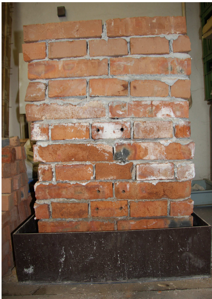
Obr. 21 : Referenční blok č.1 – bez hydroizolace, smáčený vzorek
