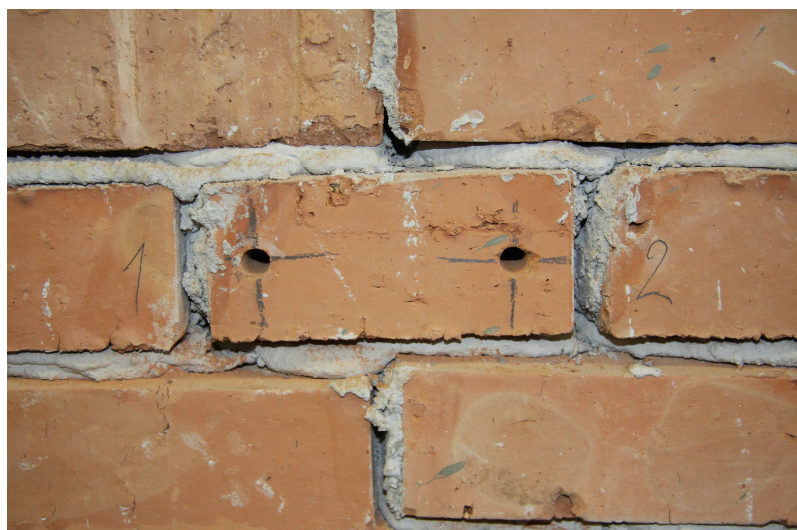
Obr. 23 : Vyvrtaný pár otvorů pro aplikaci sond
