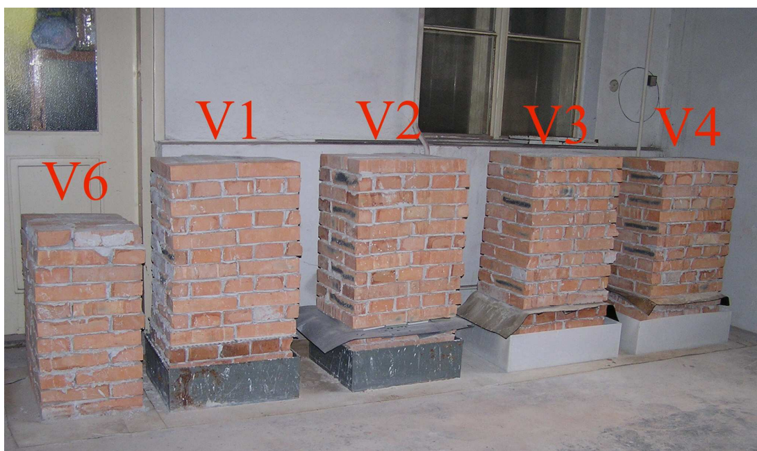
Obr. 14 : Vyzděné vzorky V1 – V4 a referenční blok č.2 – V6
