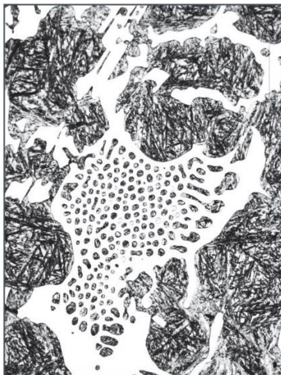
Obr. 16 Mikrostruktura ICDP litiny NTV 3 M, která se skládá z transformovaného martenzitu, ledeburitu a malého podílu kuličkového grafitu [99].
