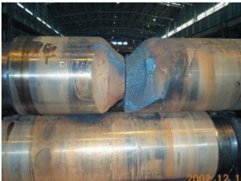
Obr. 129 Roztržení jádra pracovního válce.
