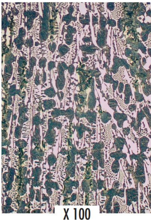
Obr. 17 Mikrostruktura ICDP litiny VEGA [107]. Vidíme základní strukturu bainitu, vysoký podíl Fe_3C a malé množství volného grafitu.
