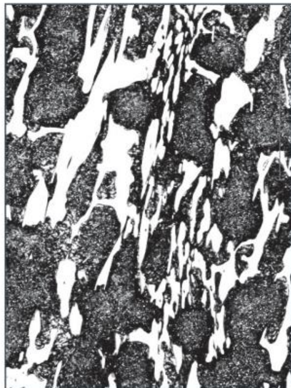
Obr. 11 Ledeburiticko-sorbitická struktura litiny s vysokým obsahem chromu OLVIT 90 M [96]. Sorbit je směsice feritu a cementitu, která vzniká při popuštění martenzitu, umožňuje vytvářet tvrdé a pevné hladké povrchy.
