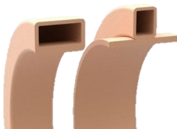
Obr. 16 Řez indukční cívky [14]
