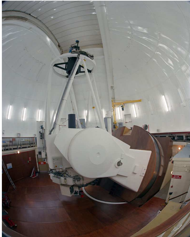
Obr. 29: Nastavitelný sklon polární osy [25]
