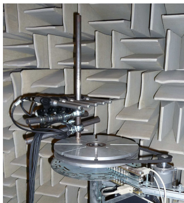
Obr. 3.2: Konstrukce pro uchycení mikrofonů na točně.
