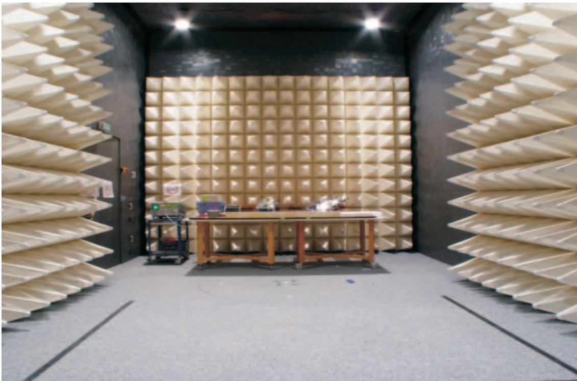
Obr. 1.2: Semi-bezodrazová komora s pevnou podlahou.
