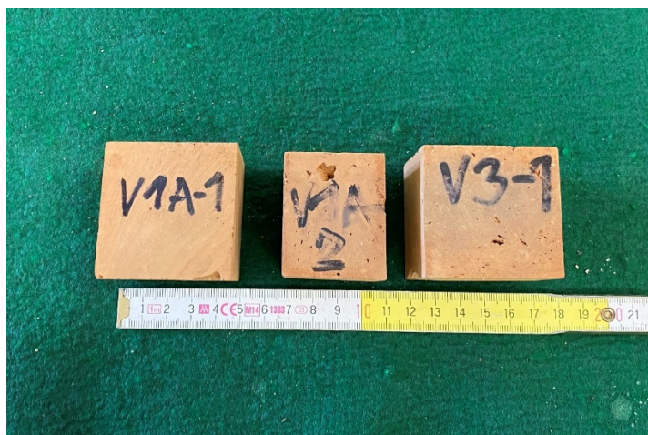
Obrázek 39 - Tělesa vyhotovena z vývrtů V1 a V3
