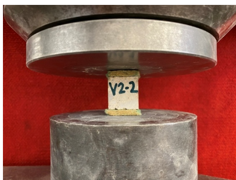
Obrázek 42 - zkouška pevnosti malt v tlaku z vývrtu V2
