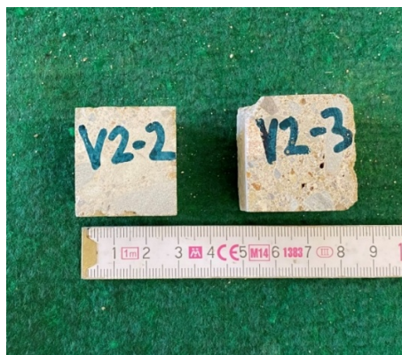
Obrázek 43 - Zkušební tělesa pro zkoušení pevnosti v tlaku malty z kamenného zdiva
