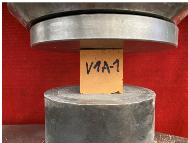
Obrázek 40 - Zkouška pevnosti v tlaku cihelného zdiva
