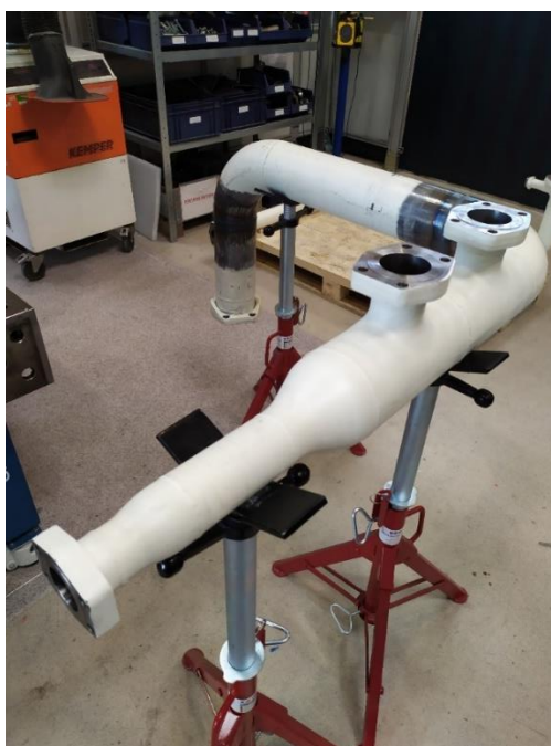
Obr. 60 Přípravek pro svařování z části svařené trubky.
