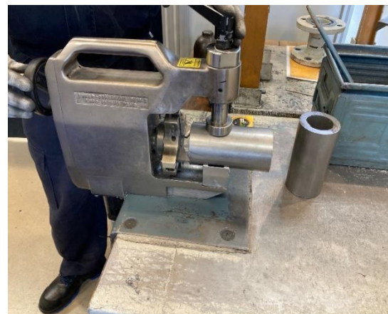
Obr. 44 Úkosování pomocí třískového obrábění.
