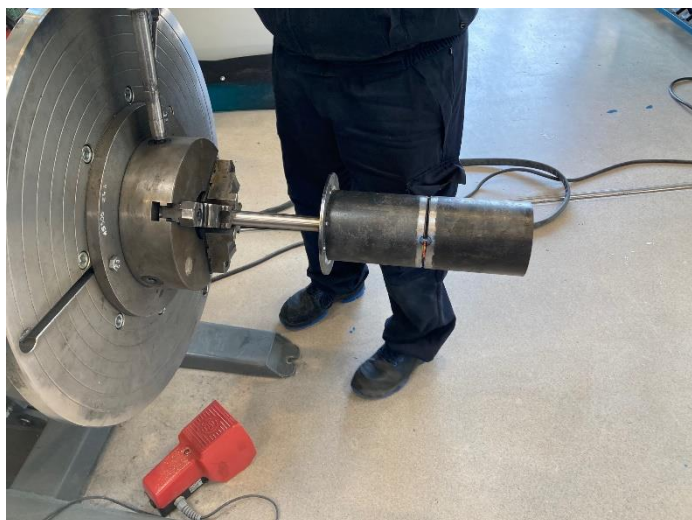
Obr. 52 Upnutí do rotačního polohovadla.
