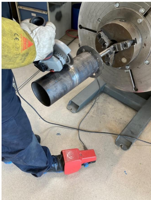
Obr. 56 Zčištění první vrstvy svaru.
