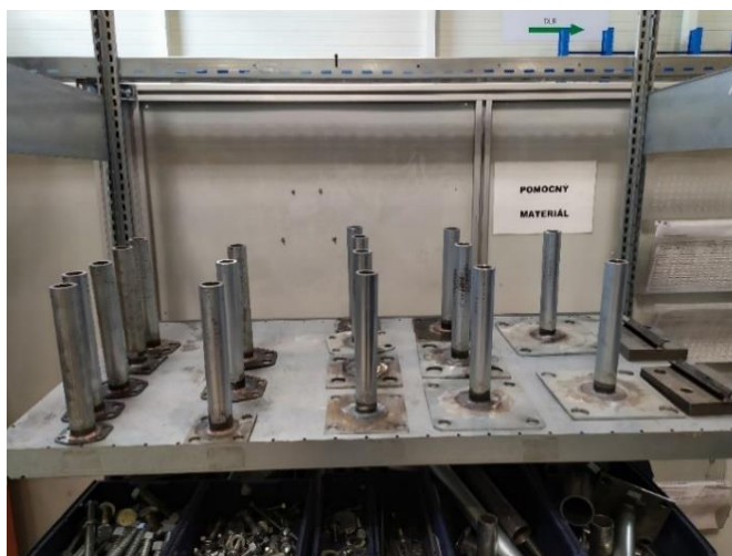
Obr. 37 Přípravek pro zabránění úniku formovacího plynu.
