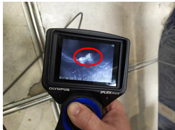
Obr. 62 Zjištění vady pomocí videoskopu.
