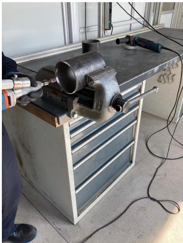
Obr. 45 Zabroušení návarové hrany.
