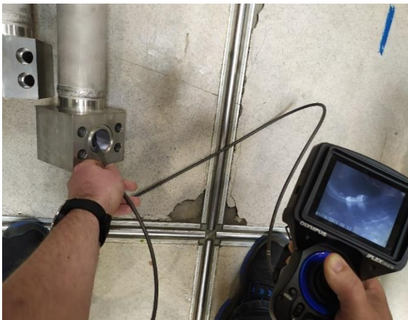
Obr. 61 Kontrola nepřístupného svaru.
