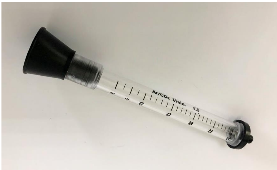
Obr. 20 Kontrolní průtokoměr na svařecí hubice hořáků [23].
