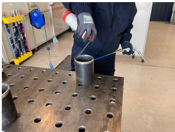
Obr. 48 Odmaštění svarové plochy.
