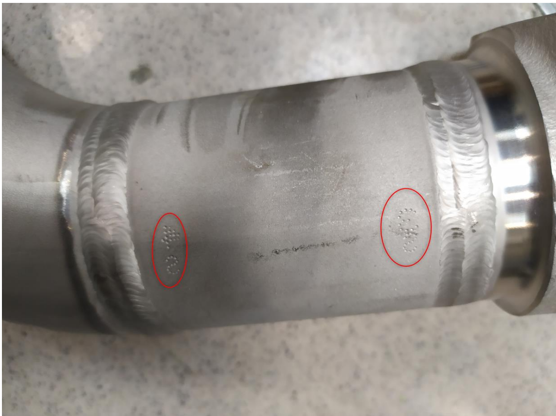
Obr. 42 Označení svarů antistresovou raznicí.
