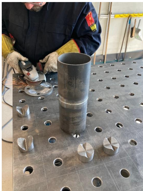
Obr. 58 Zčištění přípravku pro další použití.
