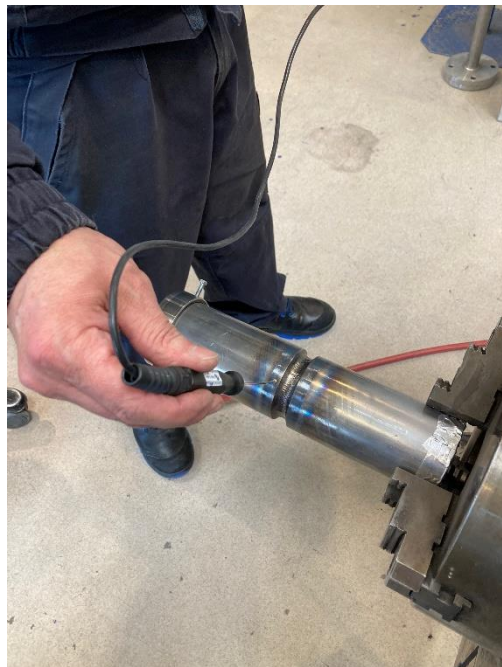
Obr. 55 Kontrola teploty interpass.
