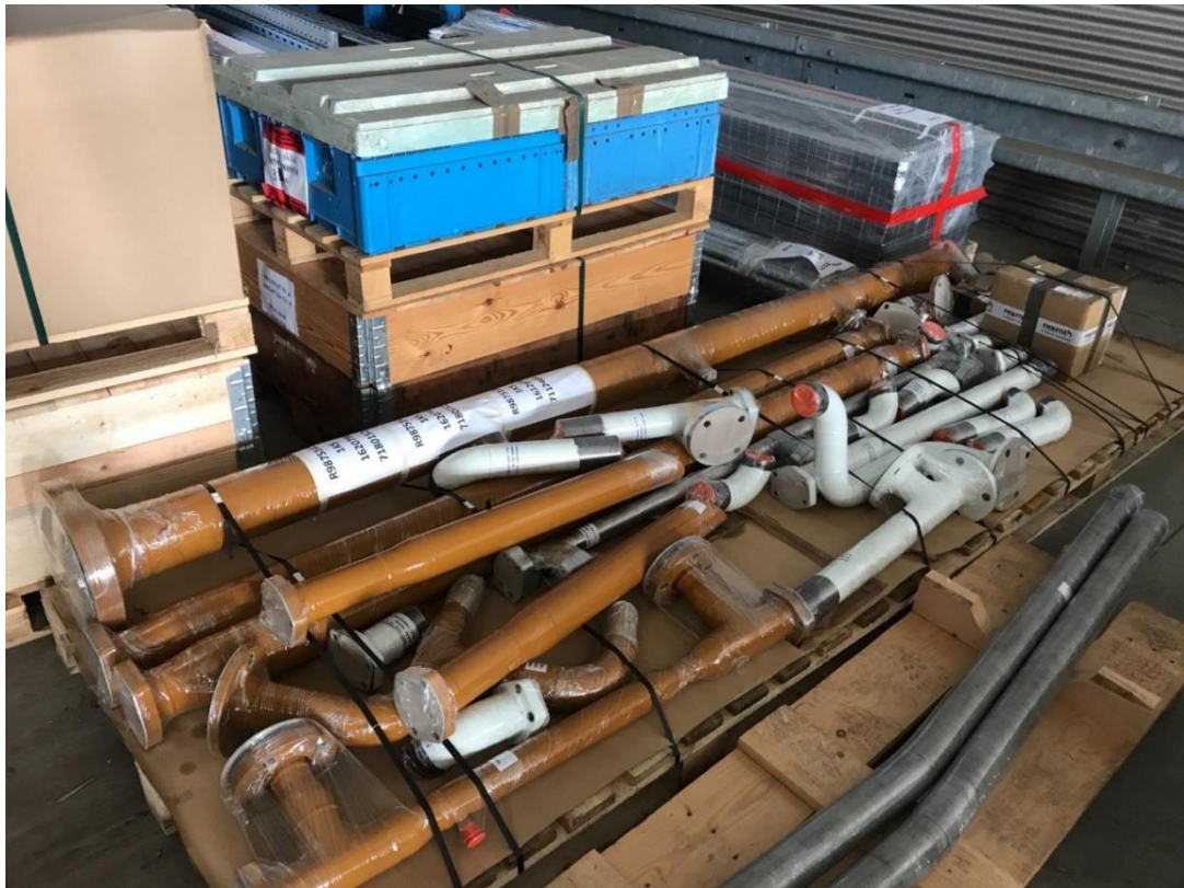
Obr. 7 Ukázka částečně svařené trubkové sady dodané externím dodavatelem.
