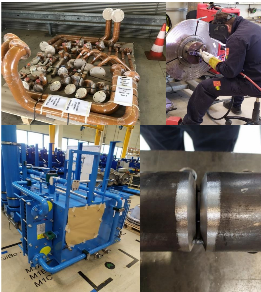
Obr. 1 Svařování nízkotlakých trubkových sad pro použití na hydraulických agregátech.
