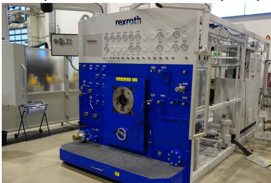
Obr. 5 Stand pro zkoušení a nastavování čerpadel.
