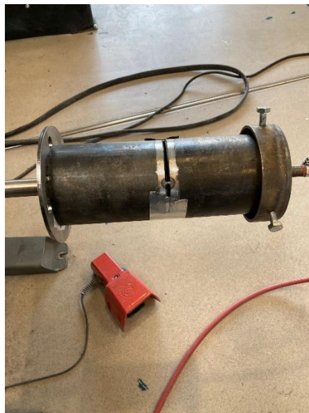
Obr. 53 Přípravek pro přívod formovacího plynu.
