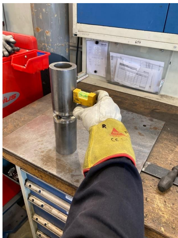
Obr. 51 Vyrovnání po stehování.
