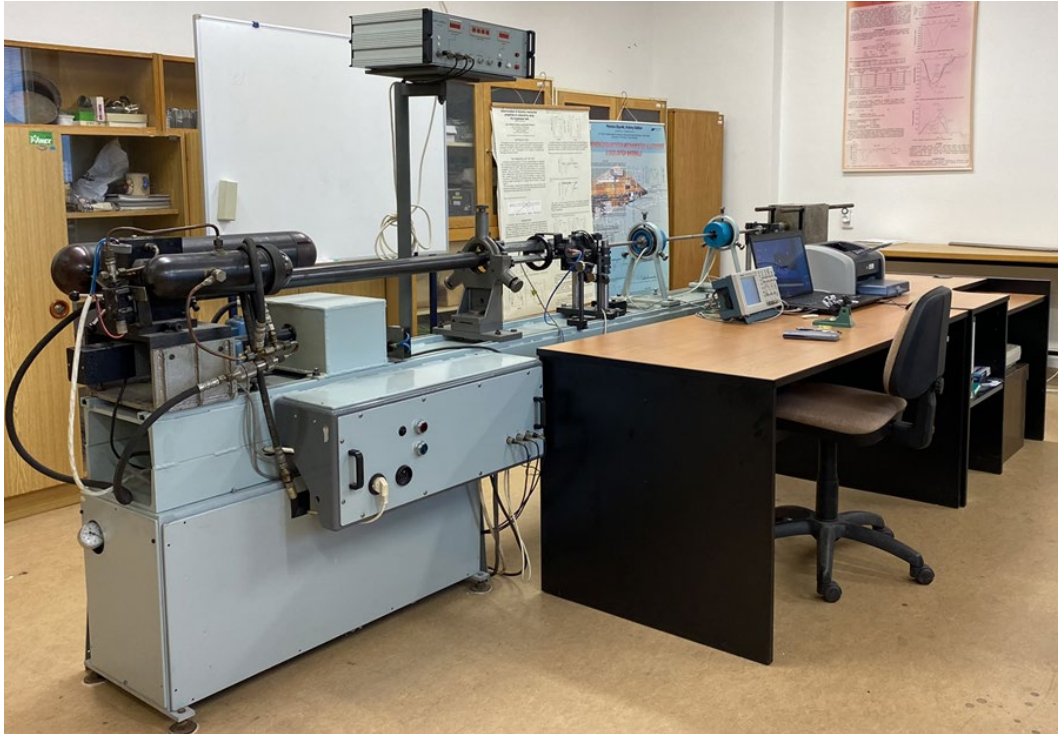
Obr. 47 Základňa pre Hopkinsonov test na Ústave strojírenské technologie Fakulty strojního inženýrství Vysokého učení technického v Brně.
