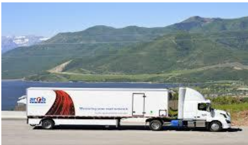
Obrázek č. 62 – TSD (Traffic Speed Deflectometer). Zdroj: Přehled metod používaných při hodnocení stavu pozemních komunikací, kolektiv z Centra dopravního výzkumu, v.v.l. 182
