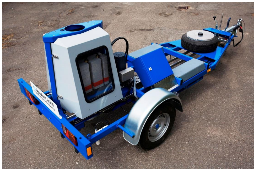
Obrázek č. 61 – FWD (Falling Weight Deflectometer). Zdroj: Bast.de 180
