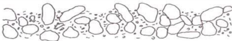
Obrázek č. 22 a 23 – Porucha netuhé vozovky dle TP 82 – Hlubková koroze. Zdroj: TP 82 153
