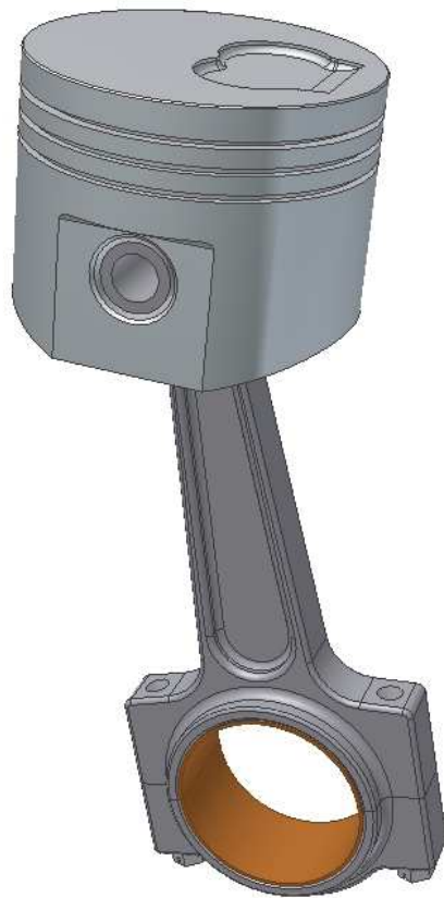
Obr. 40. Uložení ojnice a pístu - pohled 3
