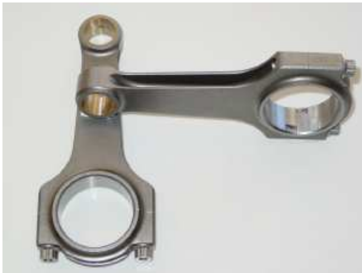
Obr. 2. Ojnice s dřívkem ve tvaru písmene H
