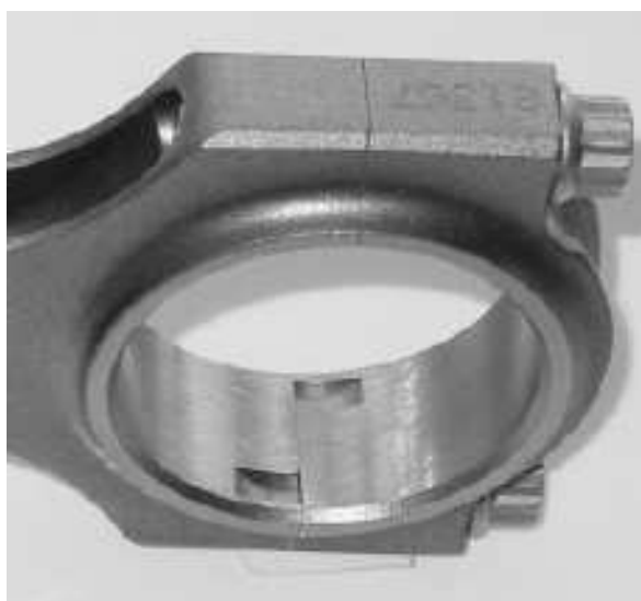
Obr. 3. Polohovací drážky hlavy ojnice
