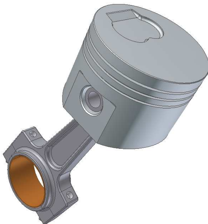
Obr. 39. Uložení ojnice a pístu - pohled 2
