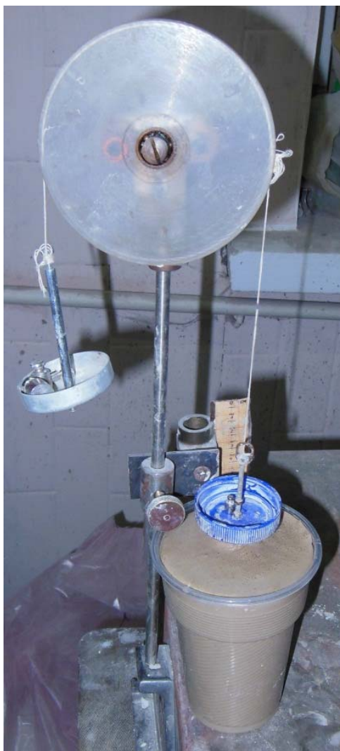
Obr. 19: Zkouška hmotnostní penetrace alkalicky aktivovaného pojiva. Levá miska slouží k vyvážení ramen před započítím zkoušky. Pravé rameno se zanořuje do zkoušeného geopolyméru.
