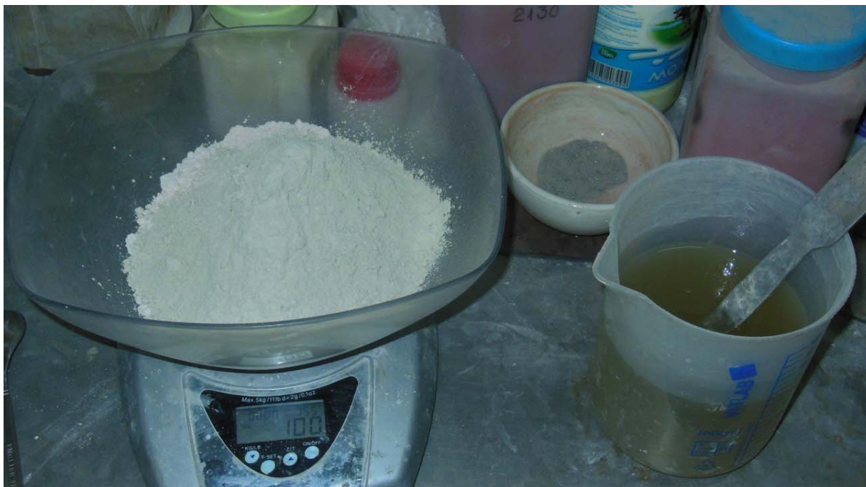
Obr. 16: Příprava alkalicky aktivovaného pojiva. Vpravo se nachází rozmíchané vodní sklo s rozpuštěným hydroxidem sodným, vlevo jsou odvážené sypké materiály – křemelina s metakaolinem.
