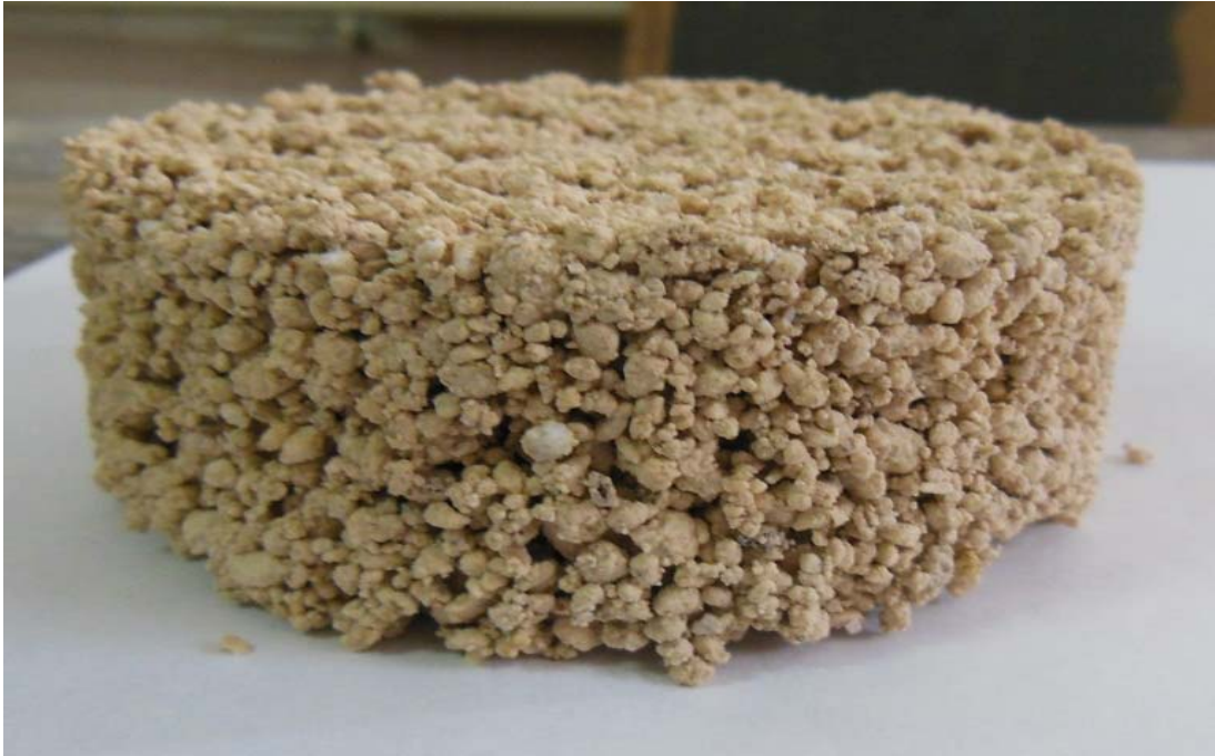
Obr. 20: Zkoušení vlastní soudržnosti alkalicky aktivovaného pojiva s přidavkem perlitu jako tepelně izolačního plniva.
