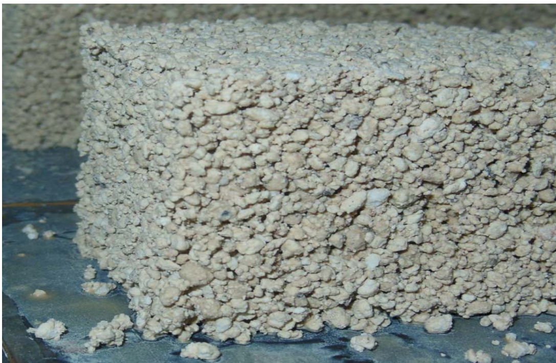
Obr. 20: Zkoušení vlastní soudržnosti alkalicky aktivovaného pojiva s přidavkem perlitu jako tepelně izolačního plniva.
