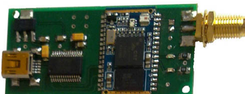
Obr. 2.4: Fotografie hotové desky sestavené na základě blokového schématu na obrázku 2.6
