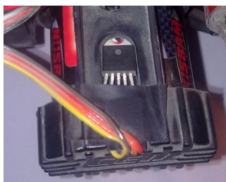
Obr. 2.23: Umístění a uchycení teplotního čidla u akumulátoru
