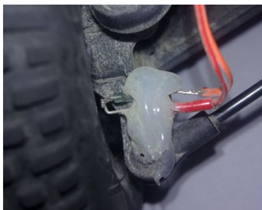
Obr. 2.20: Umístění a přilepení magnetického spínače k přednímu kolu
