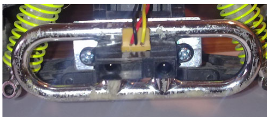
Obr. 2.22: Umístění a konstrukční uchycení IR detektoru vzdálenosti vepředu
