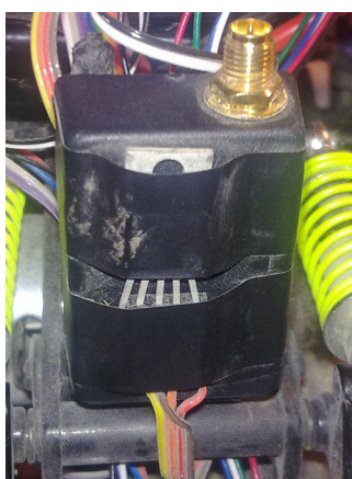
Obr. 2.24: Umístění a uchycení teplotního čidla na bluetooth modulu
