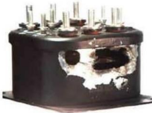
Obr.3 Poškození obloukem kovových výparů [16]
