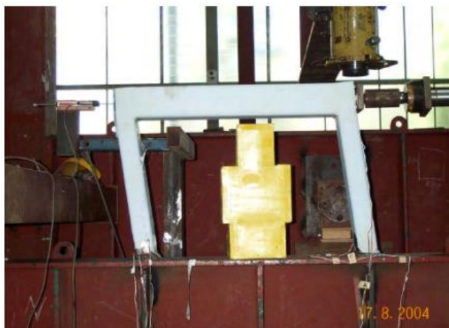
Obr. 5-10 Vychýlený tvar konstrukce ROPS při plném bočním zatížení [48].
