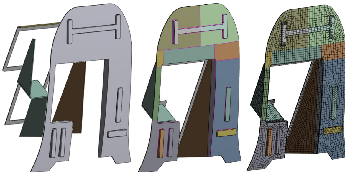
Obr. 6-19 Řešení tvorby sítě pro oblast kulisy řízení.
