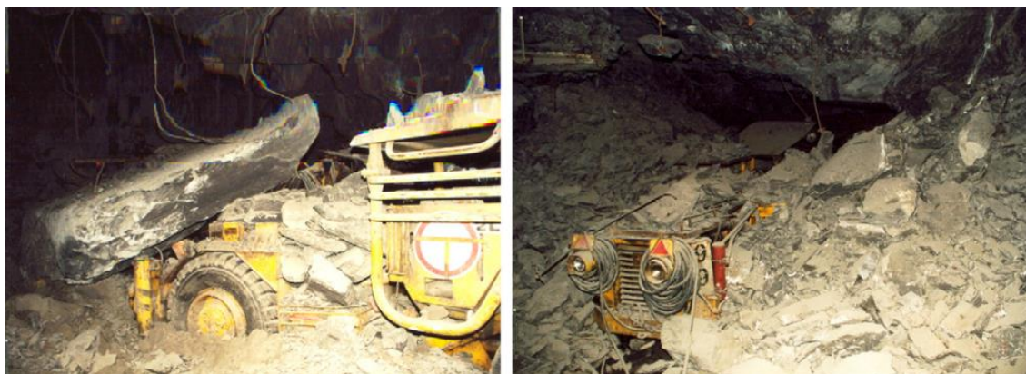
Obr. 5-2 Ochranná konstrukce zachránila život obsluze těžebního stroje v KGHM PM S.A. O/ZG LUBIN – sesuv horniny 04. 08. 2003, energie sesuvu: E = 190\,000 kJ [61].
