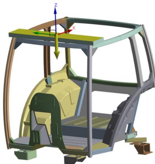
Obr. 7-24 Pozice impaktoru pro druhé svislé zatížení.
