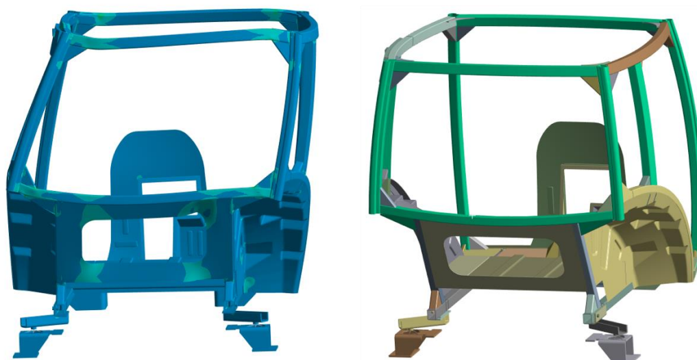
Obr. 7-18 Úprava tuhosti rámu. Vlevo – přílišná deformace zadních příčníků. Vpravo – definování materiálu S420 pro dílce označené zelenou barvou.
