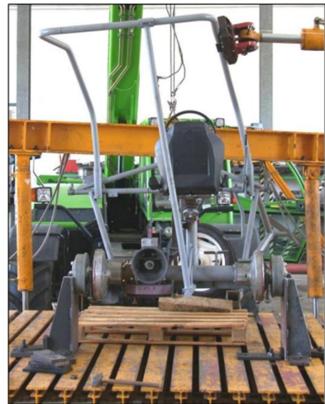
Obr. 5-13 Závislost síly na deformaci a stav na konci bočního zátěžného stavu zkoušky ROPS pro podávací hrábě s postranním hřebenem [50] (upraveno).
