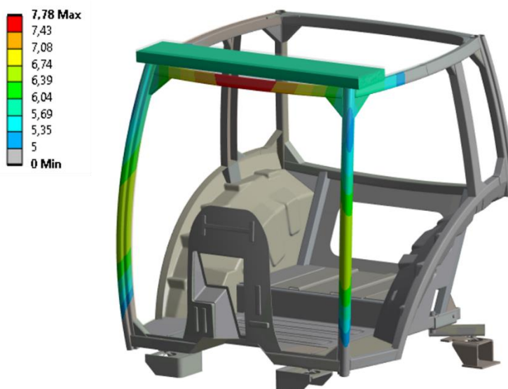
Obr. 7-26 Celková deformace kabiny [mm] – druhé podélné zatížení.
