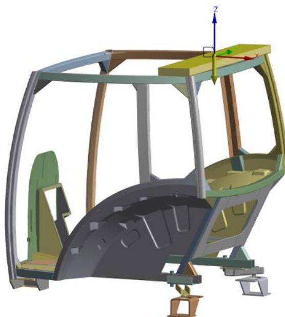
Obr. 7-12 Pozice impaktoru pro první svislé zatížení.
