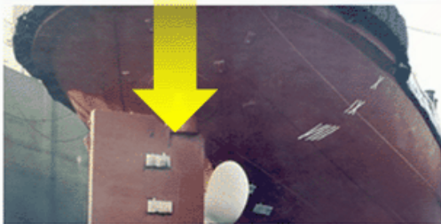
Obr. 8: Elektrochemická ochrana kormidla lodí.
