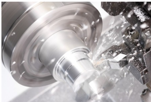
Obr. 4 Během soustružení vznikají třísky 4
