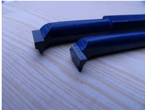
Obr. 11 Nože s pájenými břitovými destičkami 10
