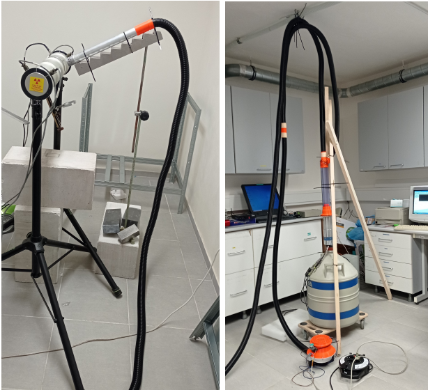
Obrázek 12: Sestavená potrubní pošta pro měření s neutronovým zdrojem.
