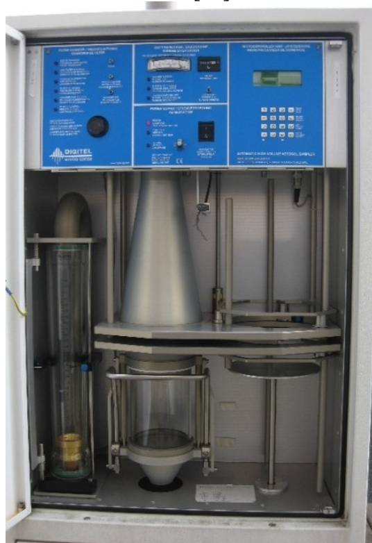
Obrázek 4: Systém velkoobjemového vzorkovače aerosolu (Digitel DHA-80)
