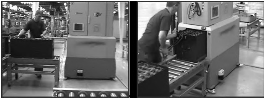
Obr. 2.4: Manuálna výmena batérie v AGV s využitím valcových dopravníkov (fotografie z výroby továrne P6 spoločnosti Hilti v Nemecku)
