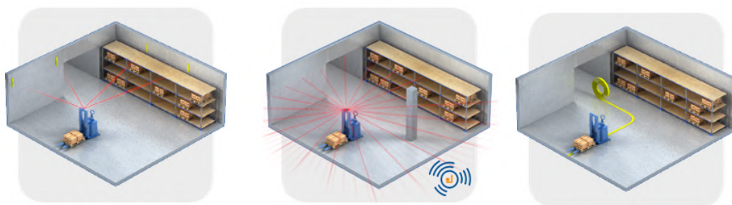
Obr. 2.1: Technológie navigácie AGV – odraz laserového lúča od fixne upevnených reflexných prvkov (vľavo), vytváranie aktuálnych máp okolia (v strede), sledovanie magnetickej vodiacej pásky (vpravo)[20]
