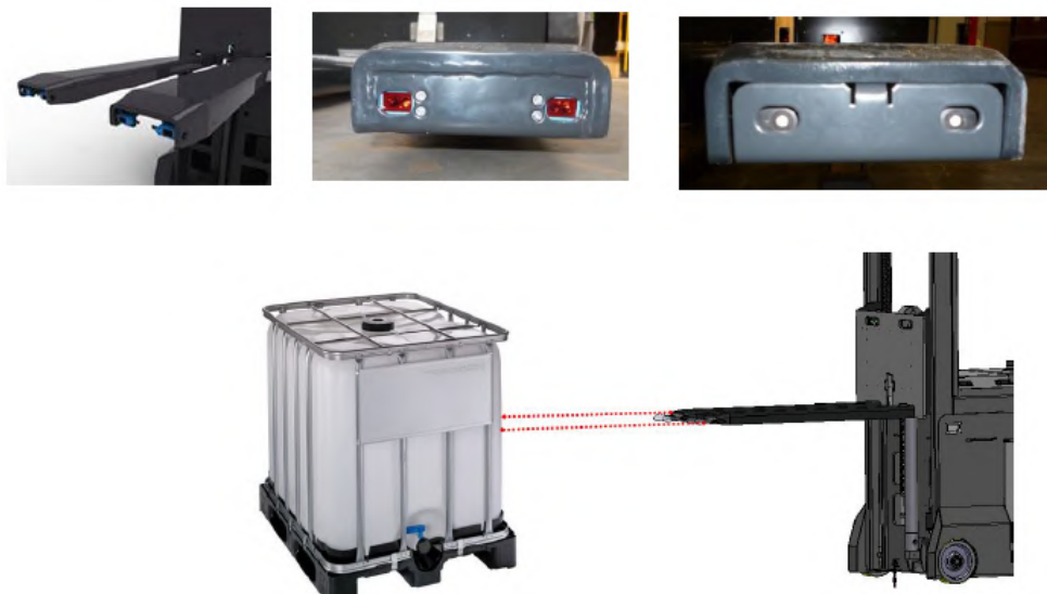
Obr. 4.2: Detekcia vzdialenosti medzi vysokozdvížnou konštrukciou a objektom; obrázky hore znázorňujú možné umiestnenie rôznych typov senzorov (zdroj: Dematic)
