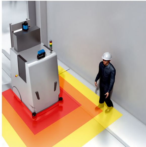
Obr. 2.6: Kolízna zóna sledovaná laserovým skenerom v smere pohybu AGV[25]
