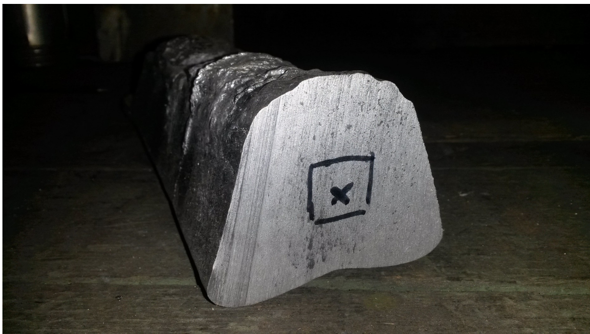
Obr. 12 Cihlový ingot ze školní slévárny. Obdélník opět značí místo odebrání vzorku
