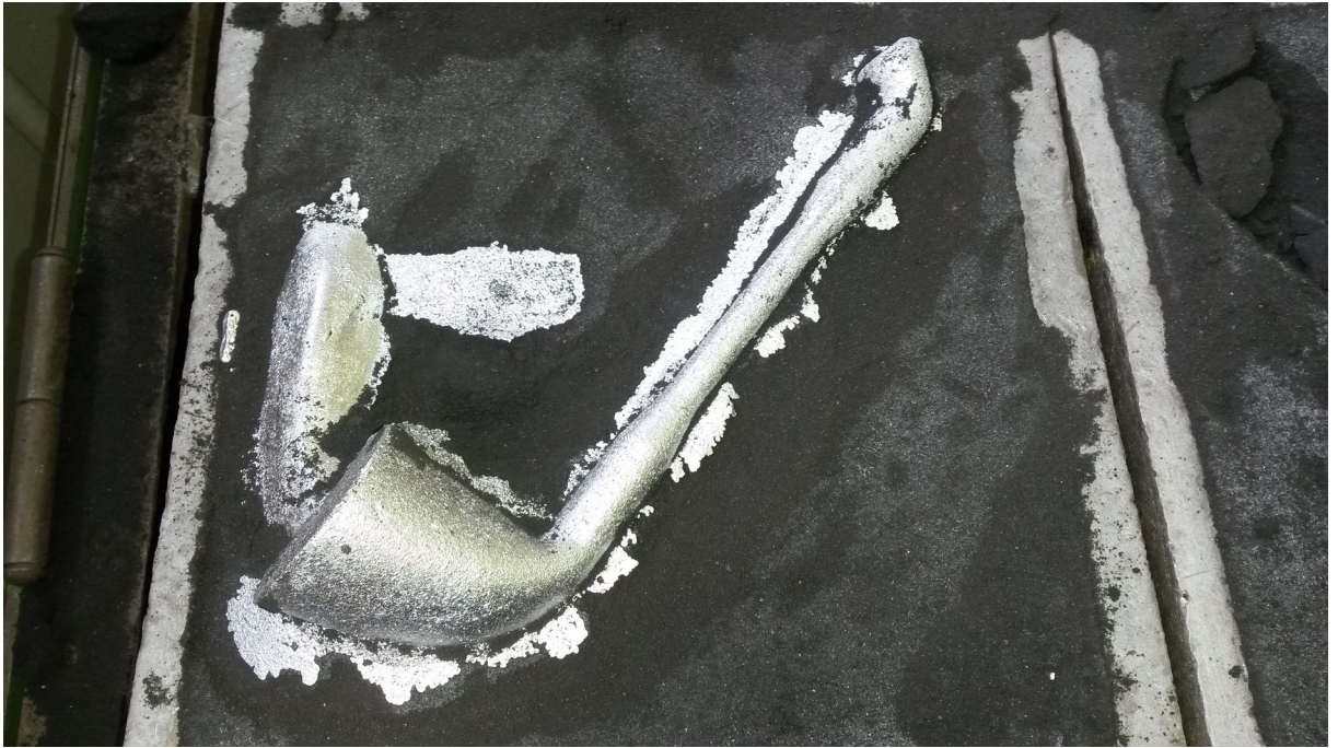
Obr. 14 Do bentonitu odlitá kopie odlitku z kokily
