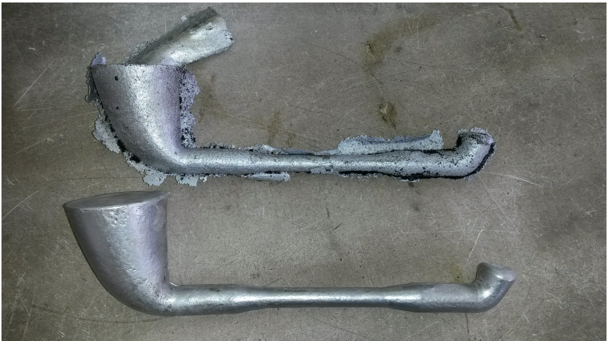
Obr. 15 Porovnání kvality povrchu obou vzorků.
