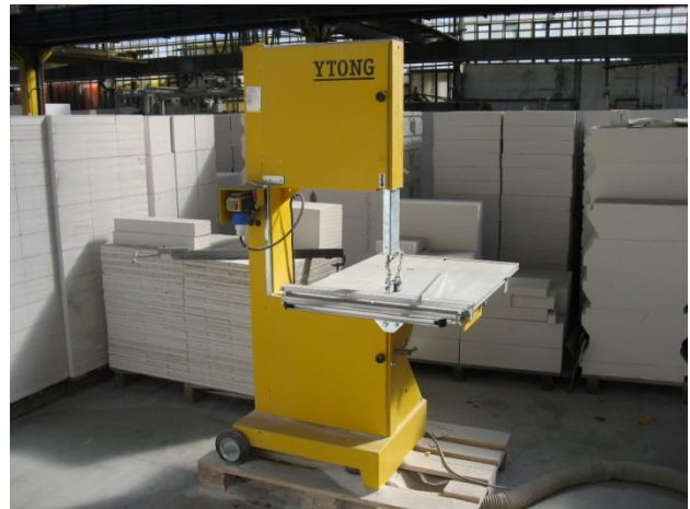
Obrázek 16 Pásová pila pro přípravu zkušebních těles
