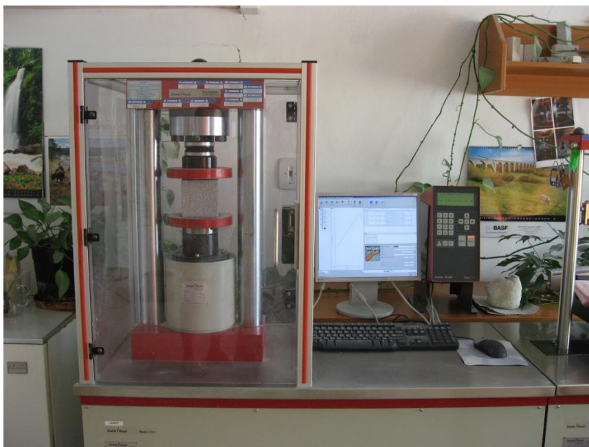
Obrázek 17 Přístroj Zwick Roell pro stanovení pevnosti v tlaku
