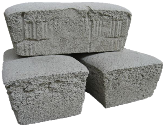
Obrázek 15 Vzorky po vyjmutí z autoklávu
