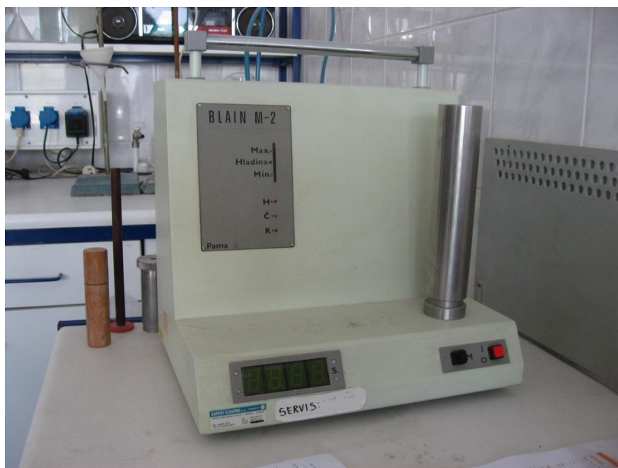
Obrázek 5 Přístroj BLAIN M-2
