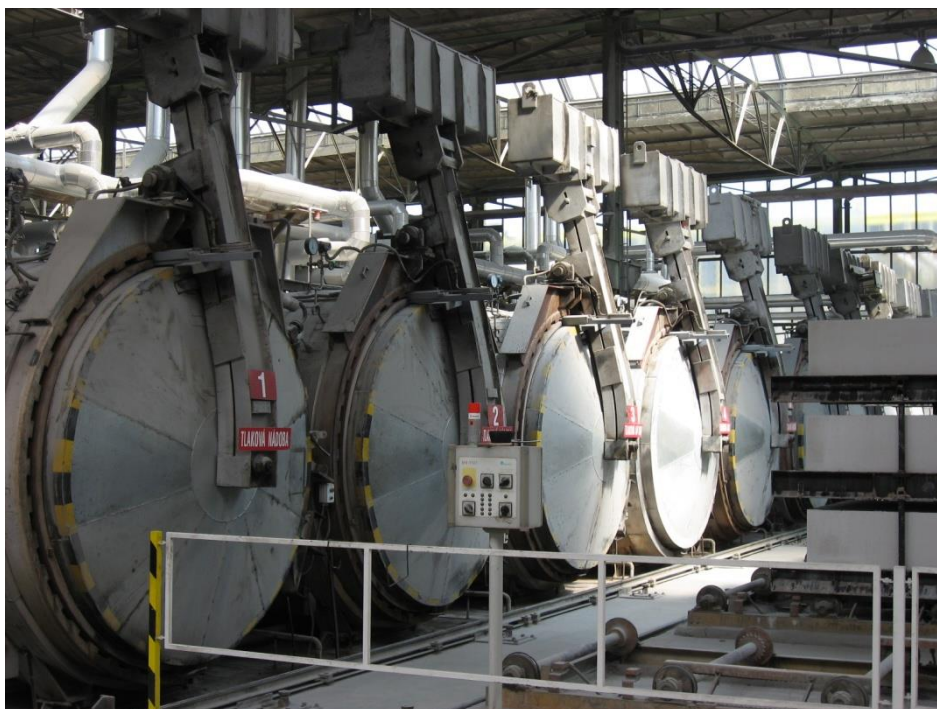
Obrázek 4 Autoklávy v závodě Xella CZ, s.r.o. v Hrušovanech u Brna
