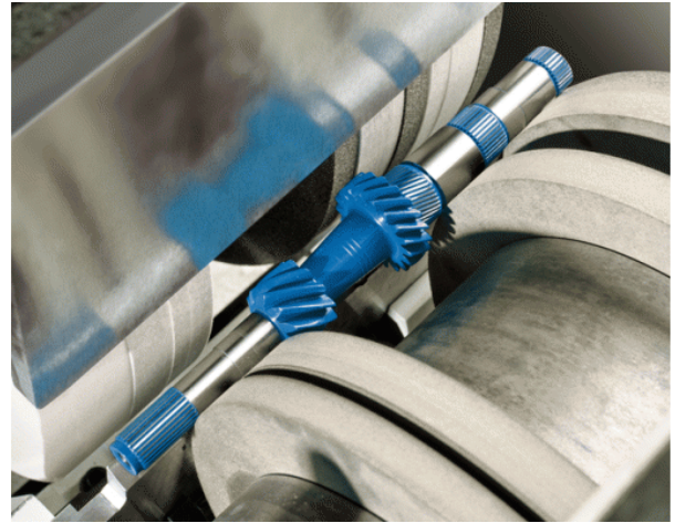
Obr.6 – příklad zapichovacího broušení firmy Junker [17]
