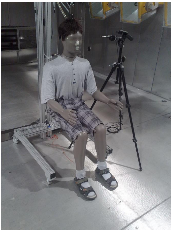
Obr. 13.4 Tepelný manekýn v letním oděvu [205]
