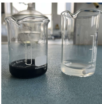
Obr. 2.13: Vlevo: aerogel s CCC-A, vpravo: čistý aerogel
