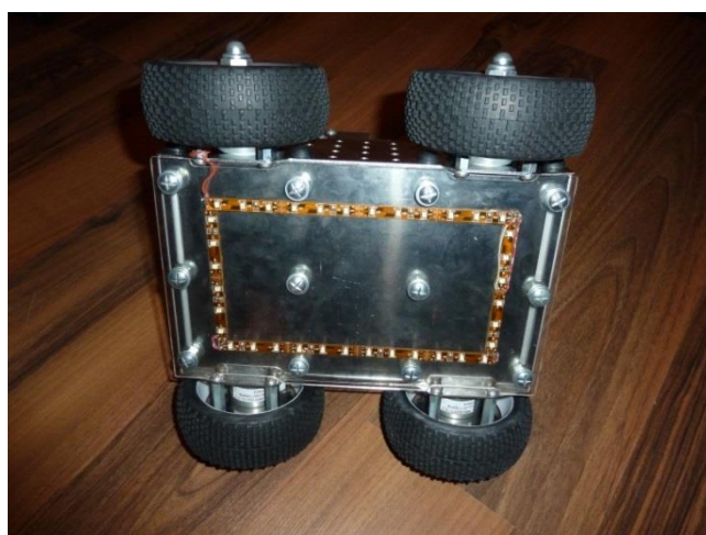
Obrázek 8-3 - Spodní strana robotu, obohacená o LED pásek
