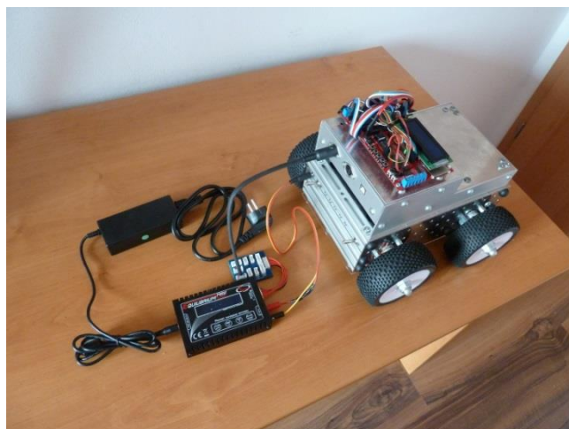
Obrázek 8-6 - Nabíjení robotu - pro spojení balanční destičky s robotem byl vyroben propojovací kabel
