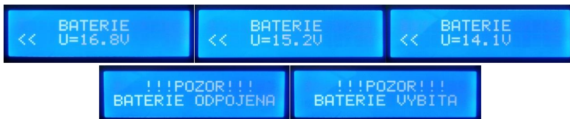
Obrázek 5-6- Stavů baterie - Nabito (vlevo nahoře), průběh vybíjení (nahore uprostřed), baterie téměř vybita (vpravo nahoře), baterie odpojena (vlevo dole), baterie vybita (vpravo dole)
