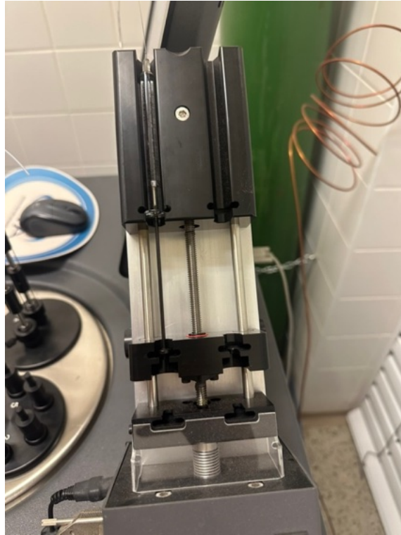
Obrázek 16: Pumpa připojená k mikrokolorimetru TAM III obsahující naplněnou stříkačku s roztokem se živinami.
