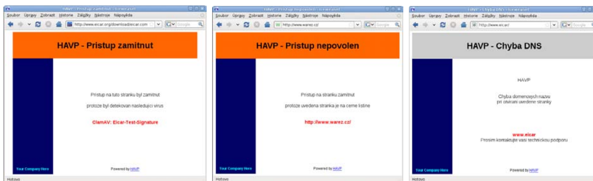
Obr. 42: Ověření správnosti konfigurace – vlevo detekce viru následovaná zamítnutím přístupu, uprostřed zákaz přístupu na stránky obsahující warez, vpravo chybně napsaný doménový název (www.eicar.org), HAVP upozorní na chybu DNS
