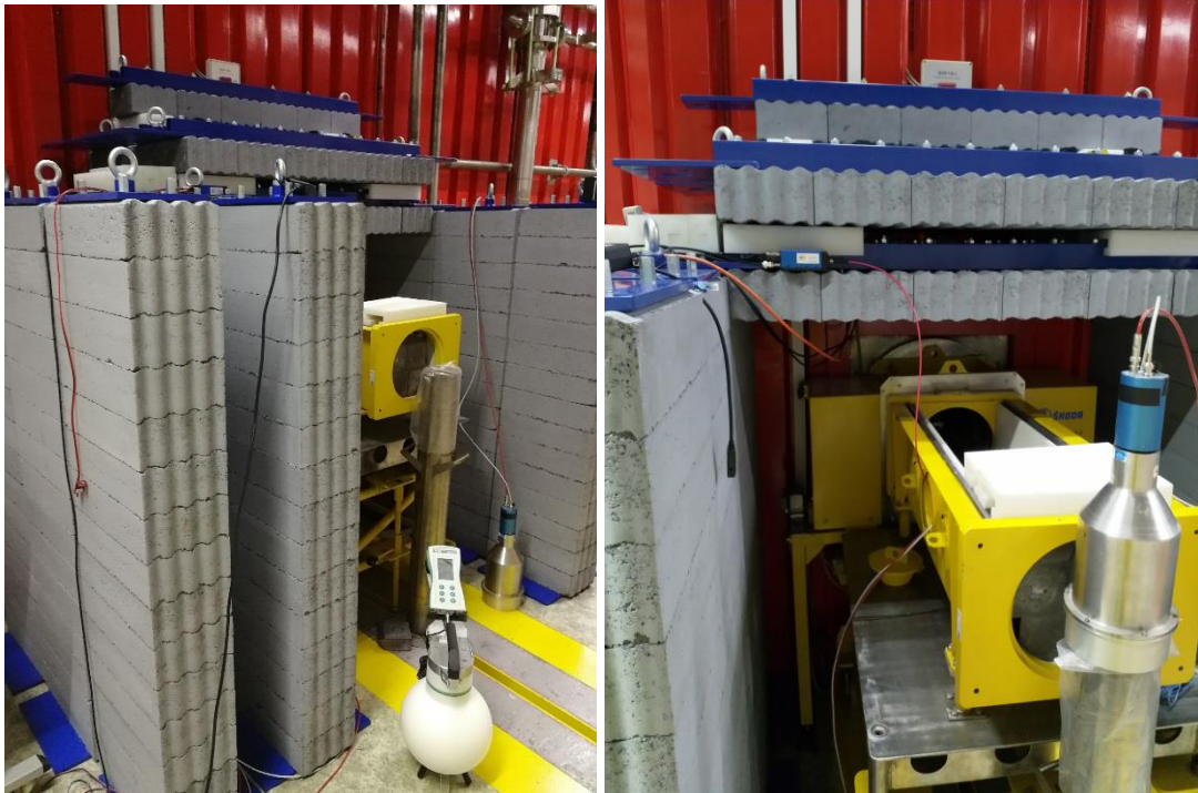
Obr. 69. Fotografie měřicího radiálního kanálu reaktoru VR-1 s umístěným optovláknovým měřicím systémem pro měření gama záření.
