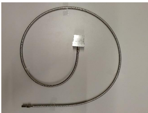
Obr. 36. konstrukce optovláknového senzoru pro měření ionizujícího záření s připojením optickým vláknem.
