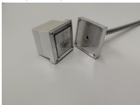
Obr. 35. Návrh senzoru: a) otevřená konstrukce senzoru pro krychlové scintilační krystaly; b) zavřená konstrukce senzoru pro scintilační krystaly o tvaru válce s připojenou optickou linkou.
