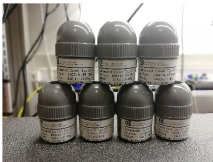
Obr. 31. Ochranné olověné kontejnery zdrojů ionizujícího záření kobaltu a cesia.
