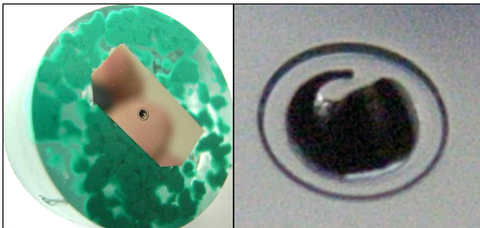
Obr.3.33. a 3.34. Foto vybroušeného řezu zalitého v pryskyřici a detailu termočláňku
