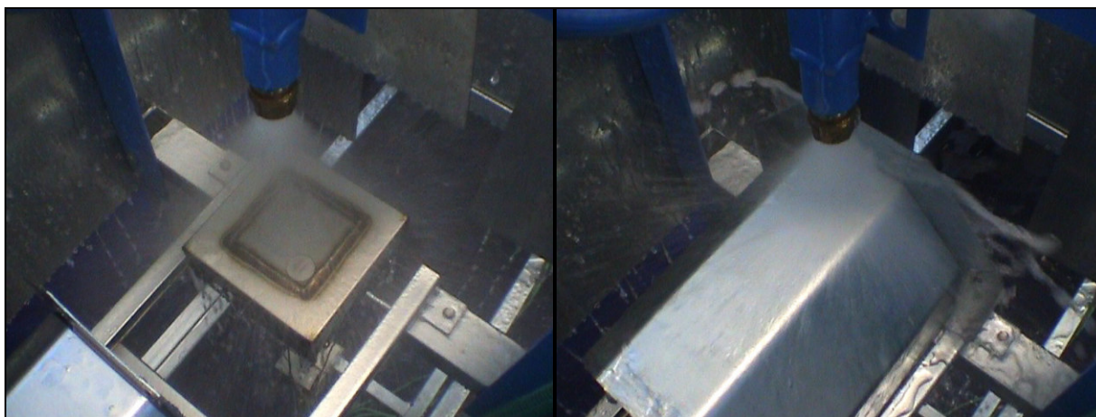
Obr.3.5. a 3.6. Pohled do chladicí sekce během ostřiku – deflektor je otevřen (vlevo) a zavřen (vpravo)
