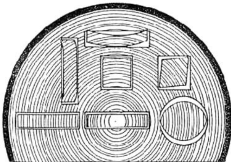
Obr. 26: Deformace dřeva při vysoušení v různých částech klády. Převzato z [33].
