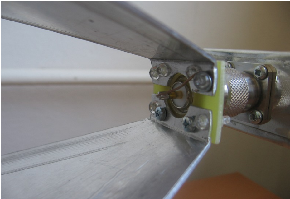
Obr.56 Připojení přizpůsobovacího obvodu (detail)
