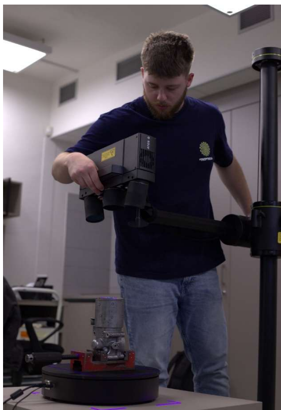
Obr. 21: Zachytený moment skenovania pomocou optického 3D skenera ATOS Q 12M, ktorý je pripravený na nastaviteľnom stojane. Snímaná súčiastka je uložená na rotačnom stolíku a pevne uchytená v pomocnom zveráku
