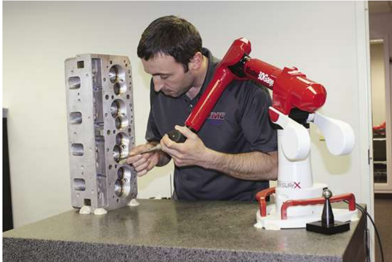
Obr. 9: Využitie prenosného CMM od spoločnosti Master3DGage na digitalizáciu valcovej hlavy z vozidla NASCAR [52]
