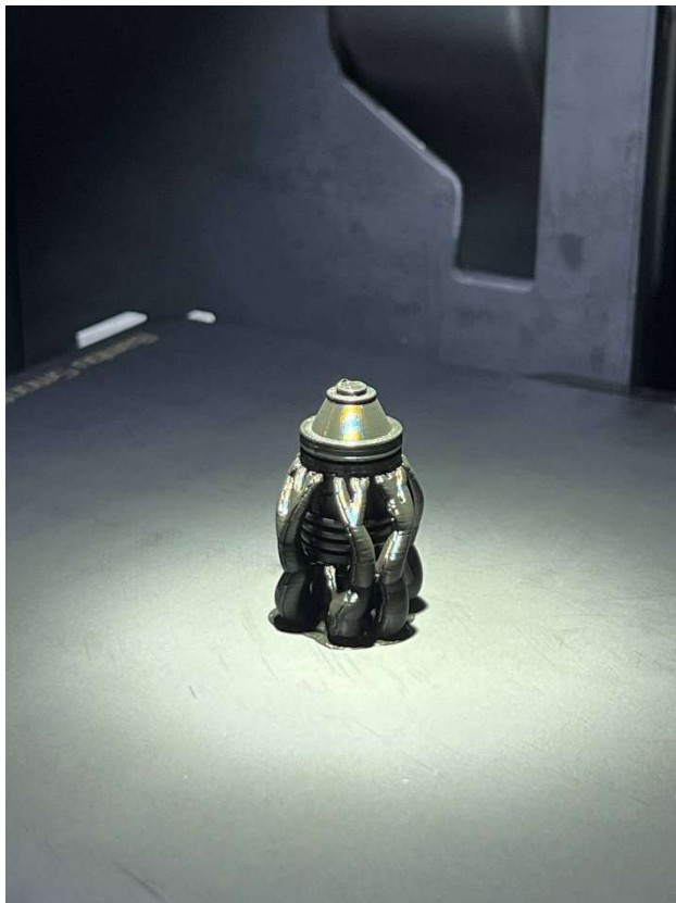
Obr. 43: Tlač modelu pretlakového ventil s využitím stromových podpôr
