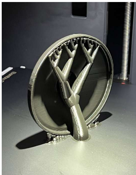
Obr. 54: Vytlačený model krytu nádržky so stromovými podporami
