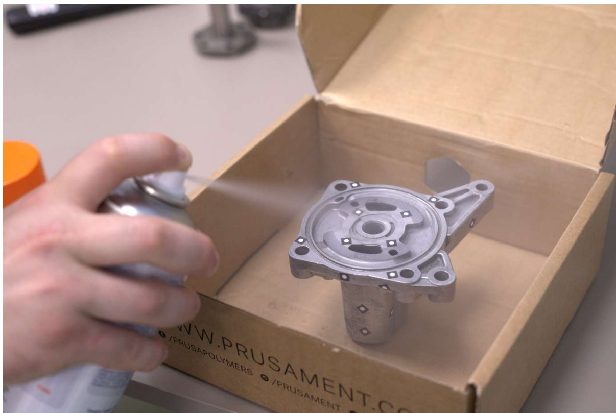
Obr. 23: Aplikácia antireflexného nástreku na menšiu časť tela čerpadla
