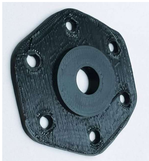
Obr. 49: Zhoršená kvalita tlače hriadeľa pri pokuse o tlač v jednom celku
