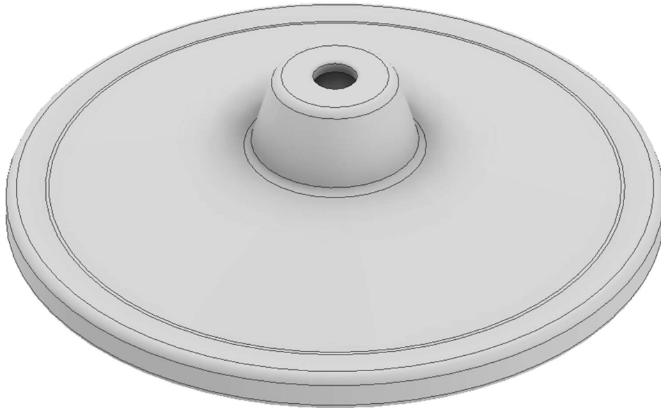
Obr. 38: Model krytu nádržky na hydraulickú kvapalinu
