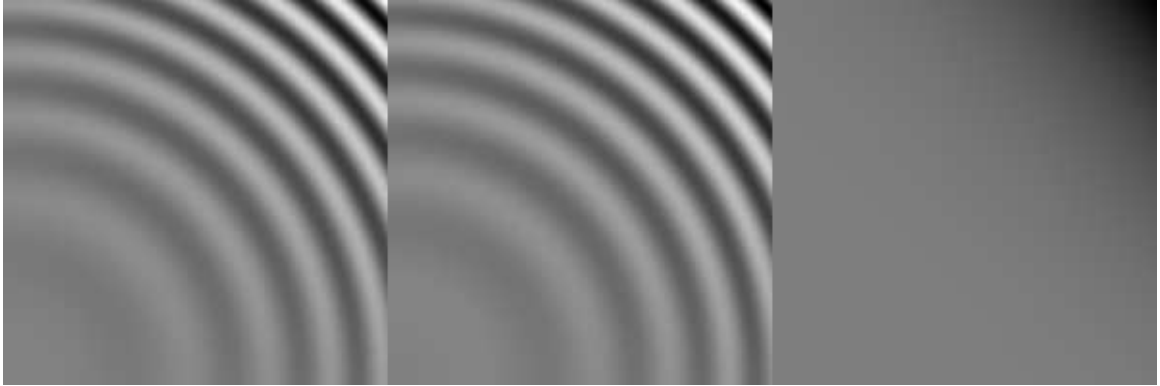
Obrázek 5.4: Metoda best-fit s parametry: dvojitý krok, rozlišení optického pole 200x200 bodů, rozměr optického pole 2mm, vlnová délka světla 500nm, počet bodových zdrojů 8x8 a rozměr „patche“ 10nm. Vlevo reálná část (černá: -27.6608, bílá 27.6608), uprostřed imaginární část (černá: -26.6789, bílá 26.6789), vpravo chyba (černá: -764.913, bílá 764.913).
