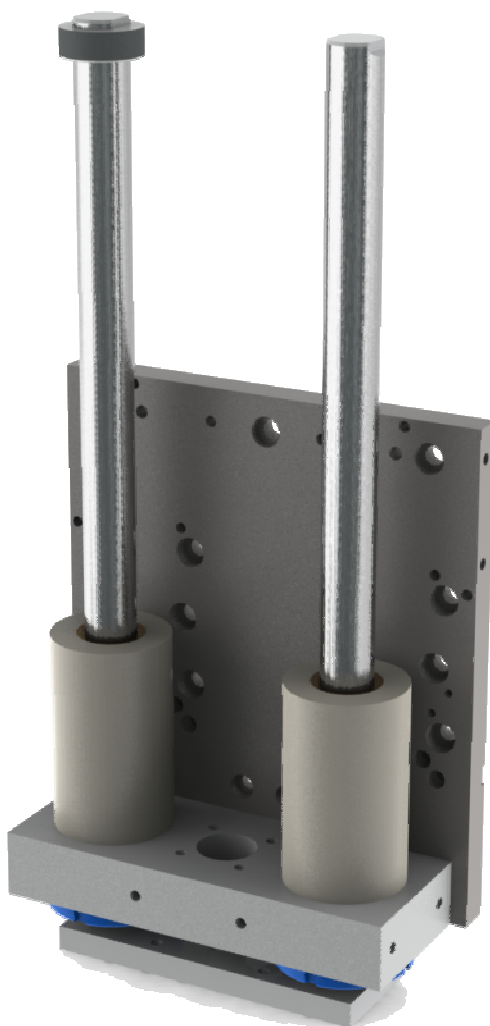
Obr. 6.6 Vozík s implementovaným vedením
