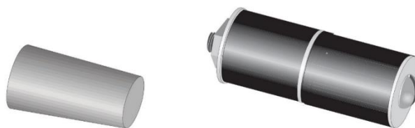
Obr. 3.4: Kovová/dubová (vlevo) a pryžová (vpravo) zátka [37]
