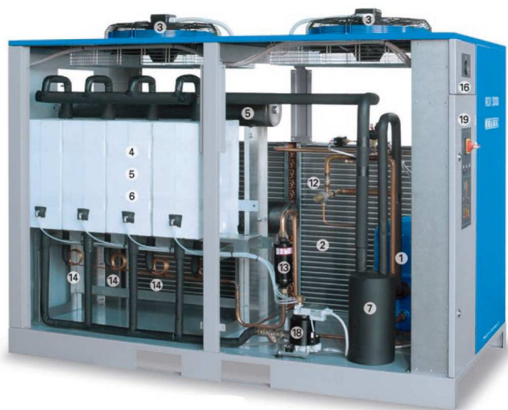
Obr. 4.7 Sušička MDX 50000 - schopná odvlhčit 3000 m 3 /h [14] 1 – Chladivový kompresor, 2 – Kondenzátor chladiva, 3 – Ventilátor, 4 – Výparník, 5 – Separátor kondenzátu odloučené vlhkosti, 6 – Výměník vzduch/vzduch, 7 – Sběrač chladiva, 12 – Obchozí ventil horkého plynu, 13 – Filtr (dehydrátor), 16(19) – Ovládací panel, 17 – Filtr hrubých nečistot (ochrana vypouštěcího systému), 18 – Automatické odpouštění kondenzátu
