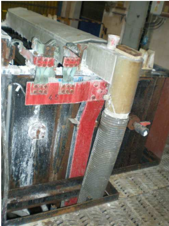
Obr. 2.2. Kladná elektroda připojená do lázně s elektrolytem
